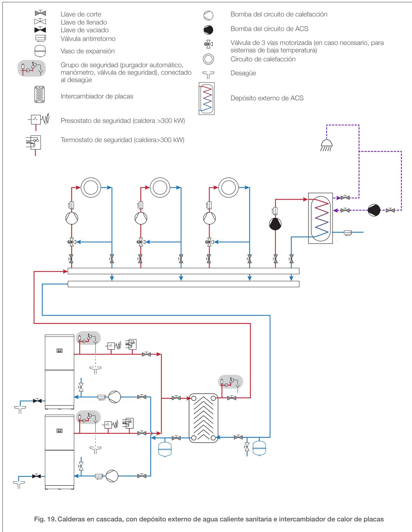
Fig. 19. Calderas en cascada, con depósito externo de agua caliente sanitaria e intercambiador de calor de placas
