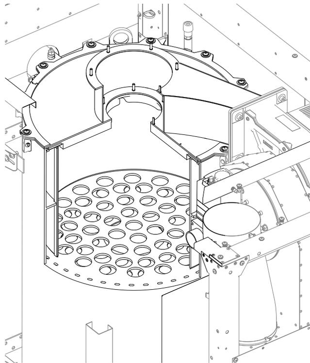
Fig. 40. Limpieza de la cámara de combustión (con placa del quemador instalada)
