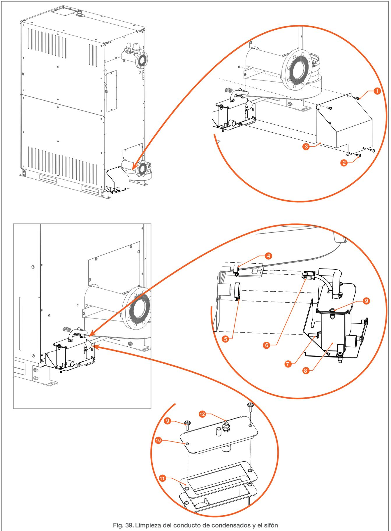
Fig. 39. Limpieza del conducto de condensados y el sifón
