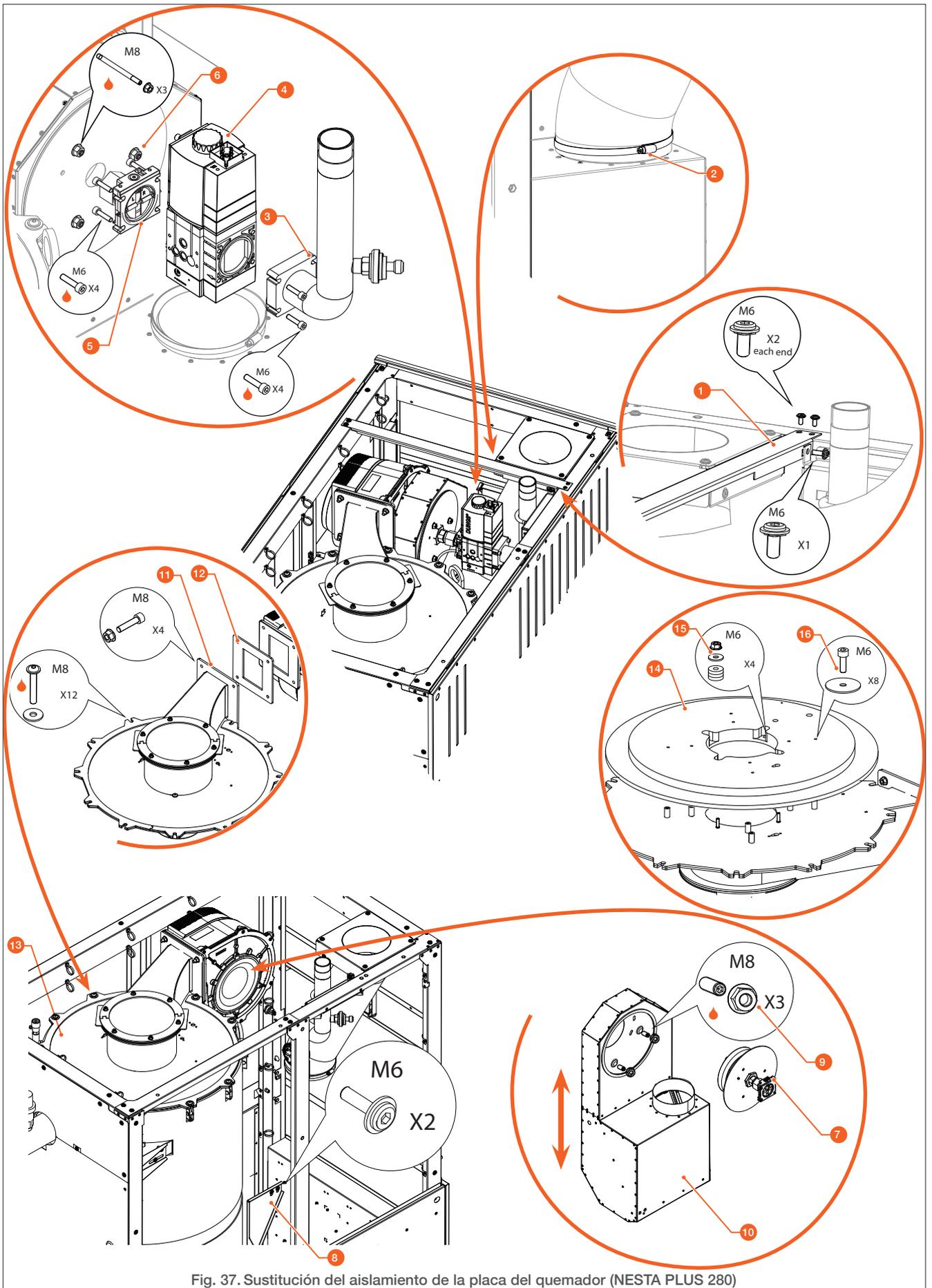
Fig. 37. Sustitución del aislamiento de la placa del quemador (NESTA PLUS 280)
