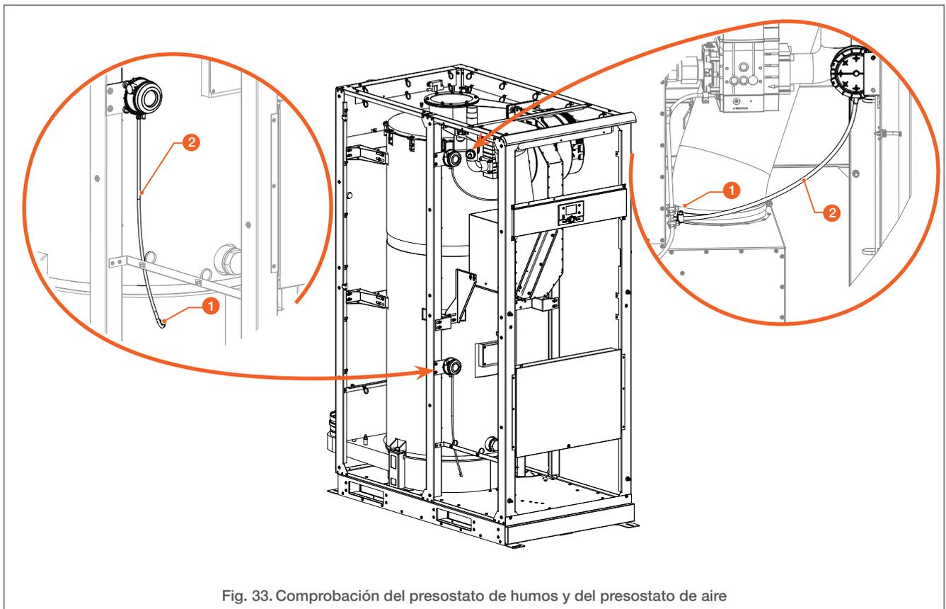
Fig. 33. Comprobación del presostato de humos y del presostato de aire
