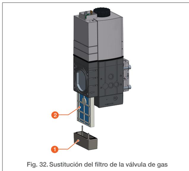
Fig. 32. Sustitución del filtro de la válvula de gas
