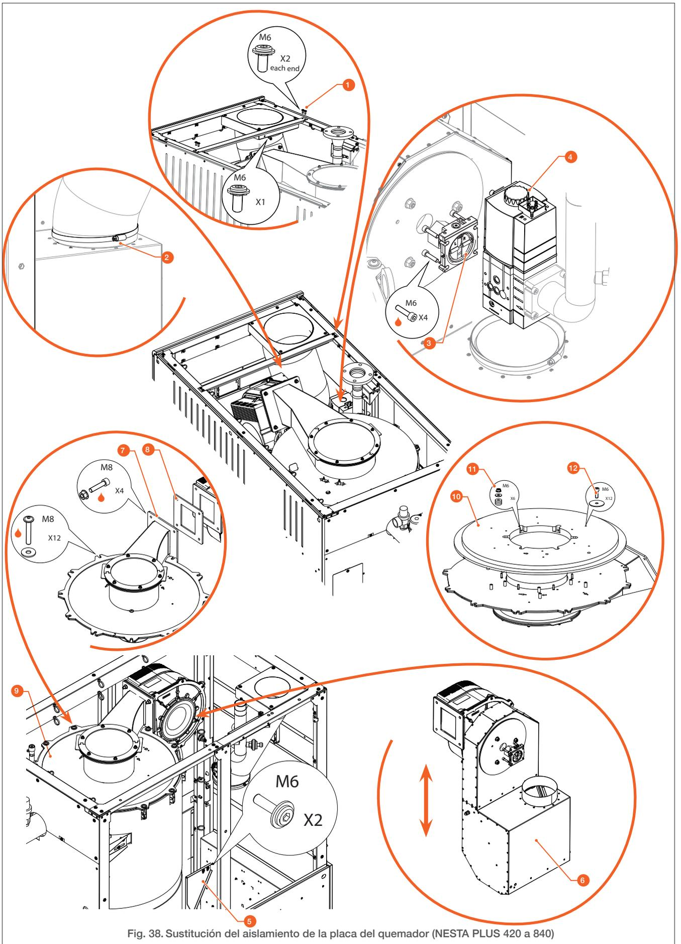
Fig. 38. Sustitución del aislamiento de la placa del quemador (NESTA PLUS 420 a 840)
