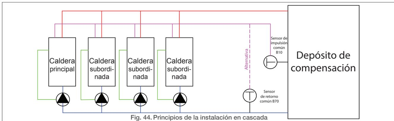
Fig. 44. Principios de la instalación en cascada
