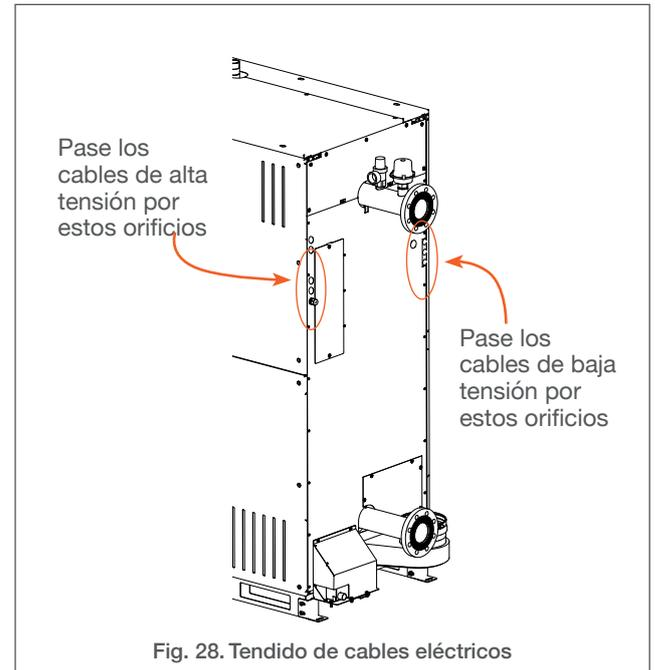
Fig. 28. Tendido de cables eléctricos
