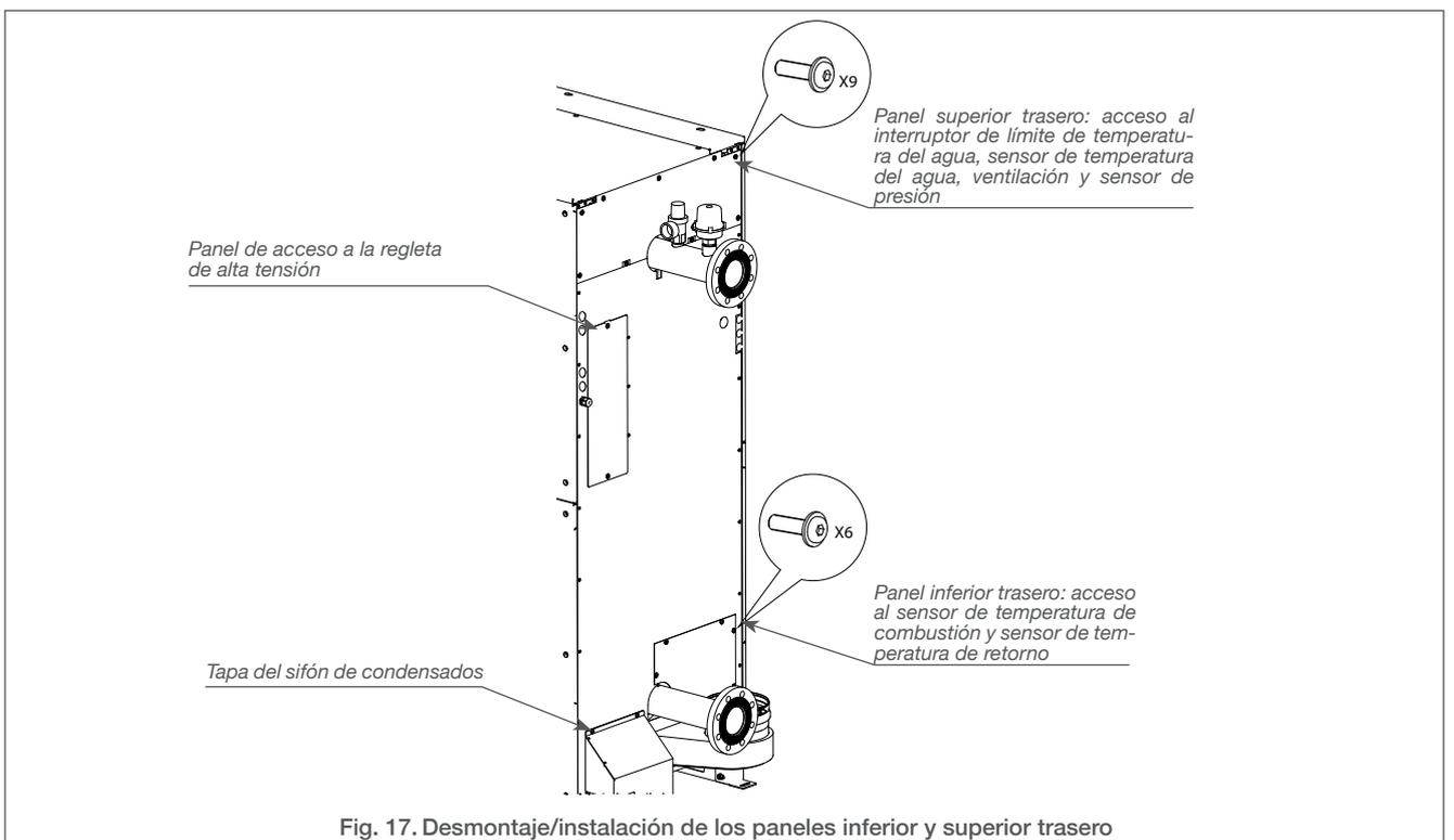
Fig. 17. Desmontaje/instalación de los paneles inferior y superior trasero
