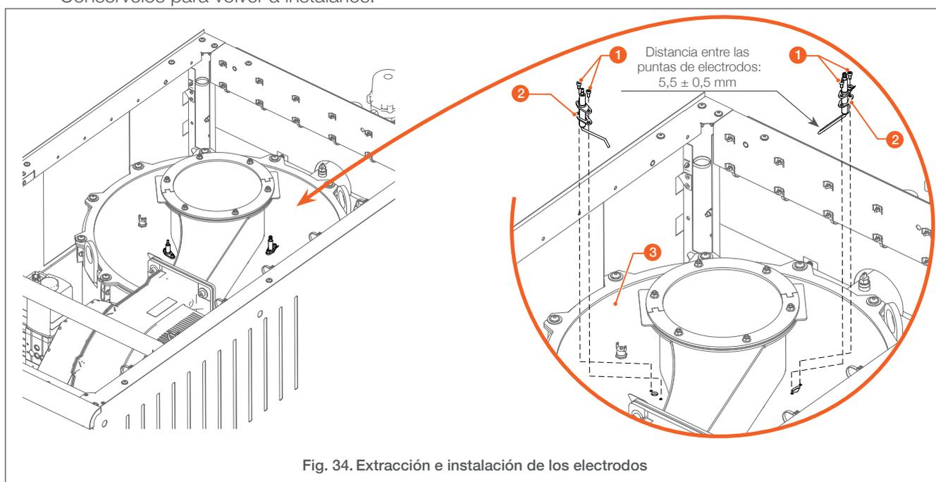
Fig. 34. Extracción e instalación de los electrodos
