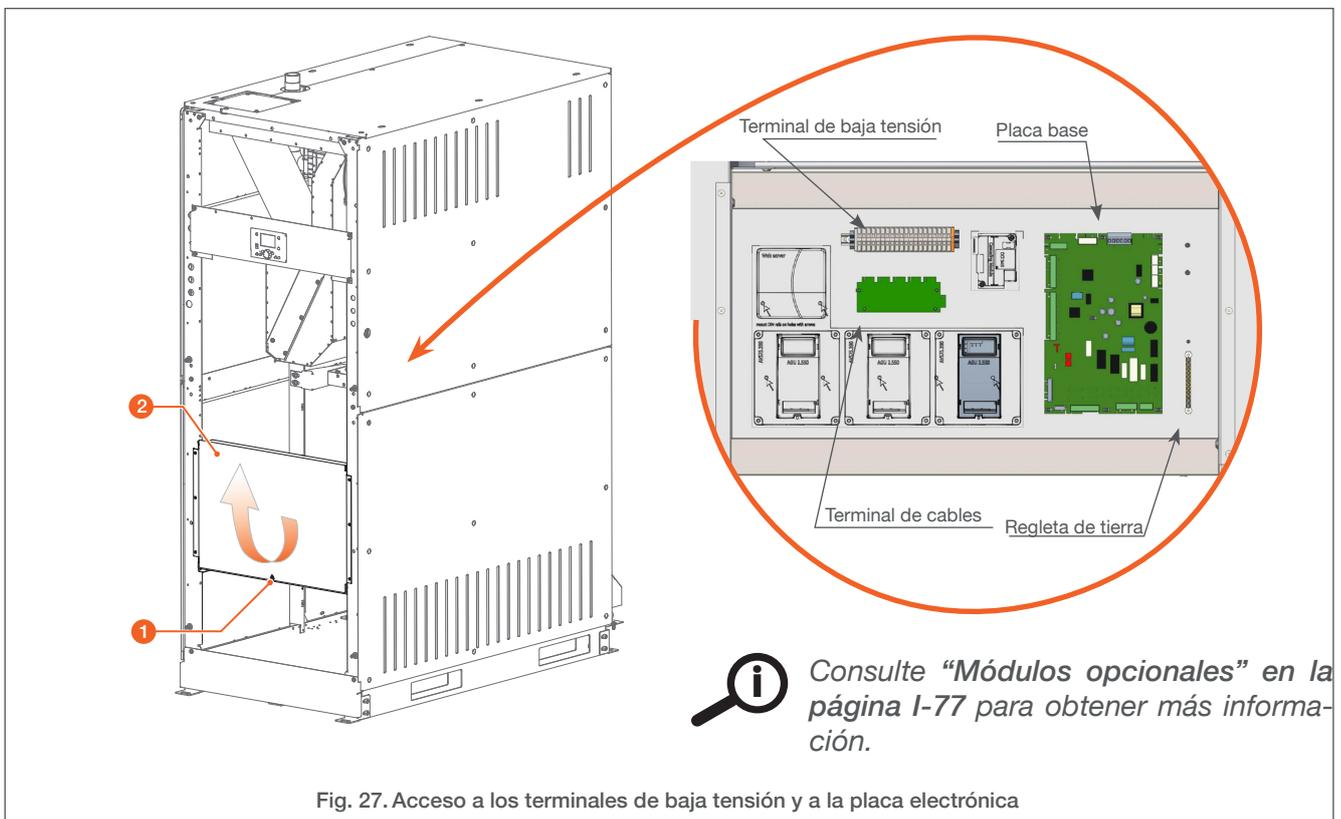
Fig. 27. Acceso a los terminales de baja tensión y a la placa electrónica
