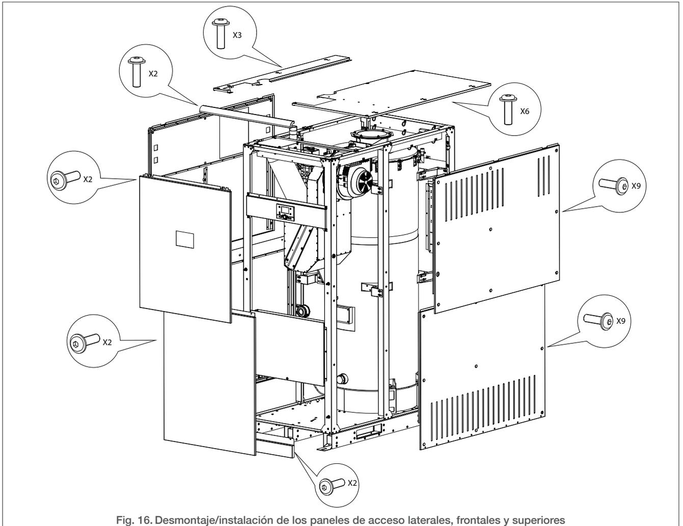
Fig. 16. Desmontaje/instalación de los paneles de acceso laterales, frontales y superiores
