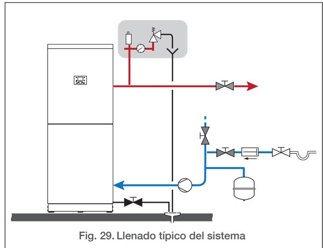
Fig. 29. Llenado típico del sistema
