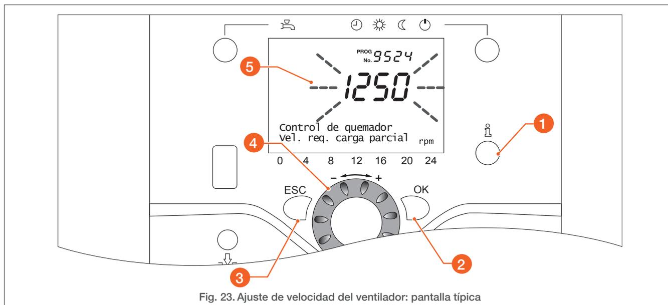
Fig. 23. Ajuste de velocidad del ventilador: pantalla típica
