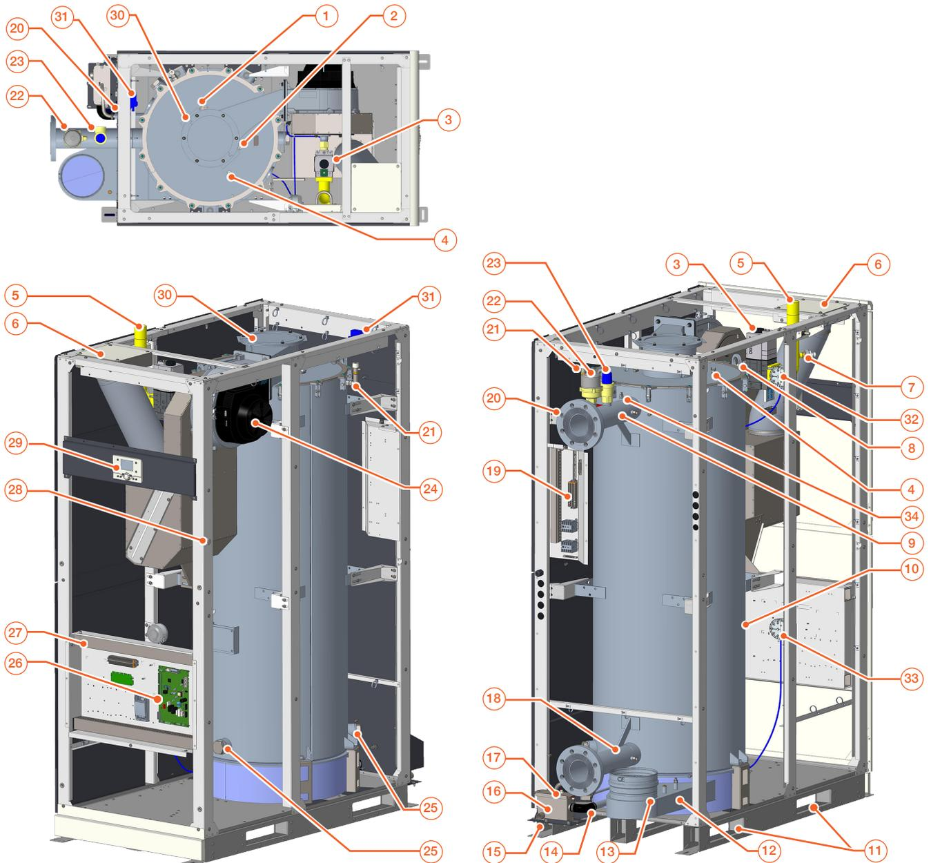
Fig. 3. Componentes de NESTA PLUS 280 - 420: vistas superior, frontal y trasera
