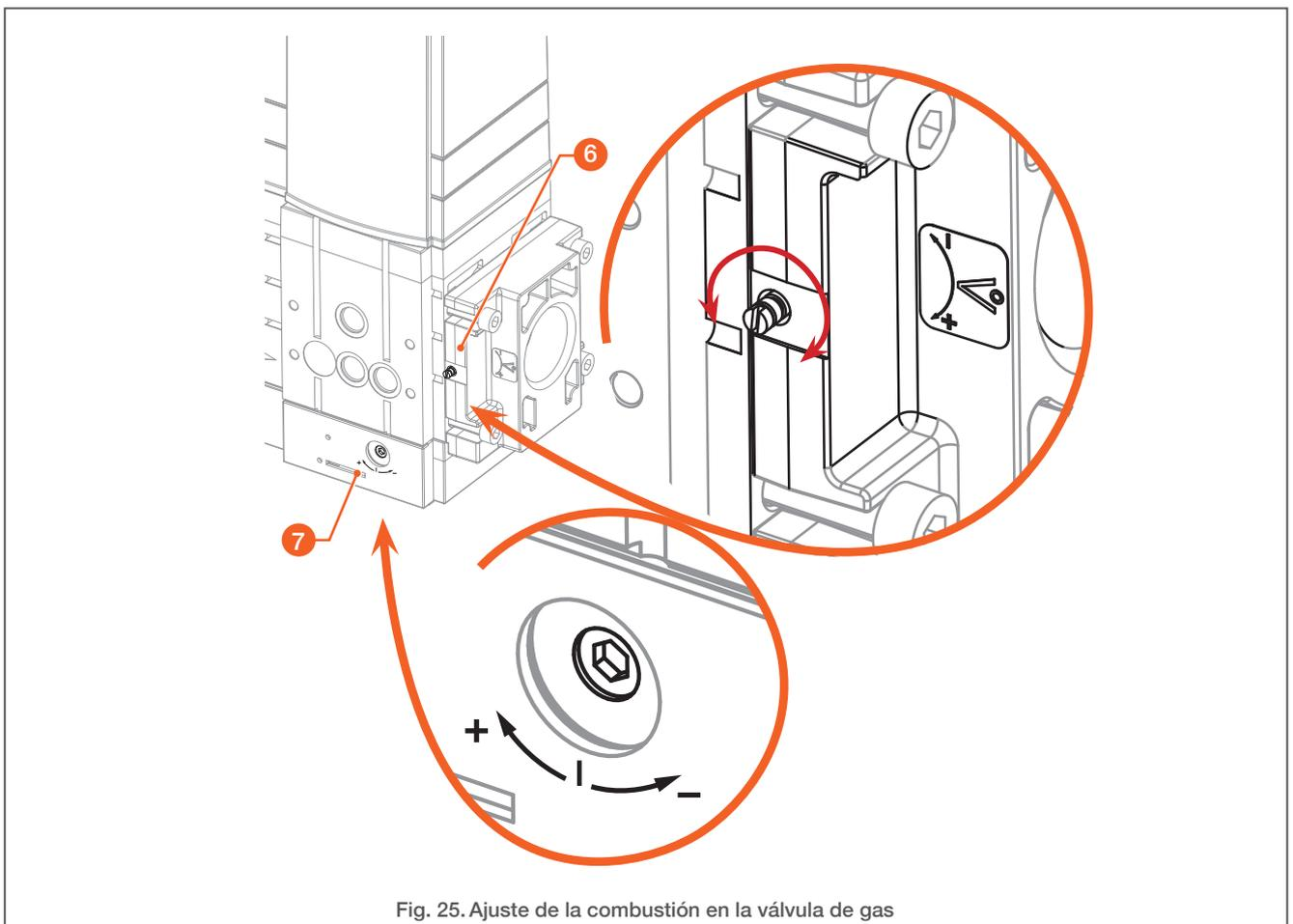
Fig. 25. Ajuste de la combustión en la válvula de gas
