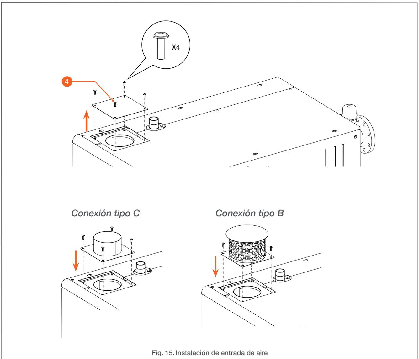
Fig. 15. Instalación de entrada de aire
