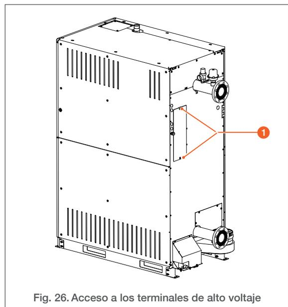
Fig. 26. Acceso a los terminales de alto voltaje
