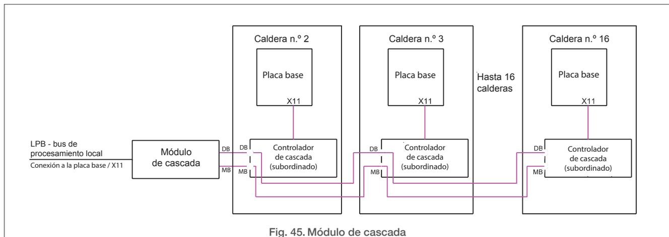
Fig. 45. Módulo de cascada
